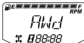
Es gibt keine zeitliche Begrenzung für den Betrieb des Fahrzeugs mit zugeschaltetem Allradantrieb (AWD). Das Fahrzeug schaltet im Rückwärtsgang (R) automatisch auf Allradantrieb um, wenn sich der Schalter in der Stellung AWD befindet.
